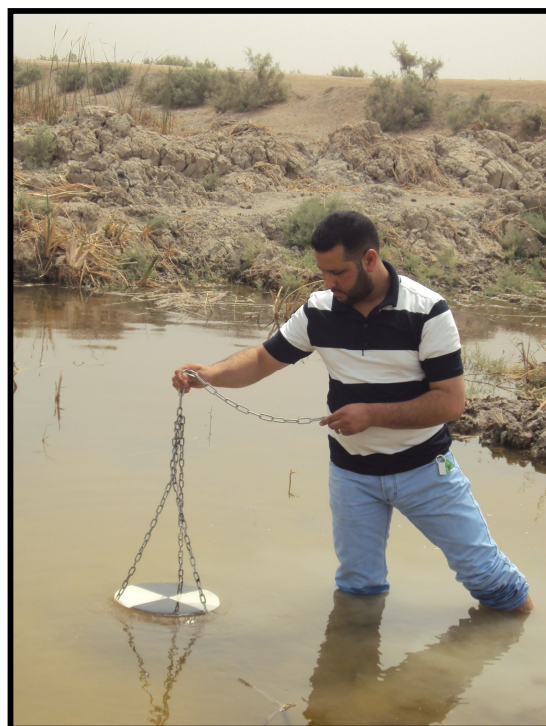
صورة (٣) قياس سرعة الجريان في هور ابن نجم صورة (٤) قياس شفافية المياه في هور ابن نجم
